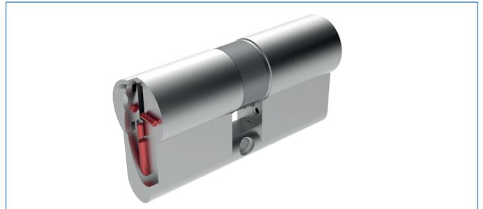
Bei Anwendung des Bohrschutzes (BS) werden die mechanischen Bauzylinder, d.h. Halb-, Doppel- und Drehknopfzylinder auf der Aussenseite mit Hartmetallstiften bestückt (in der Abbildung in Rot). Diese Hartmetallstifte schützen den Zylinder gegen Aufbohren und bieten ein Höchstmass an Sicherheit. Es wird damit die höchste Schutzklasse für Zylinder nach Norm EN 1303 resp. DIN 18252 erfüllt.
