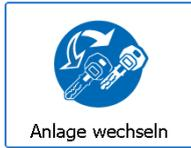
Durch klicken auf **Anlage wechseln** werden die schliessanlagen-spezifischen Berechtigungen geladen. Das heisst, je nach präsentiertem Medium wird das SEP in den neutralen, Programmier- oder Software-Modus wechseln.
