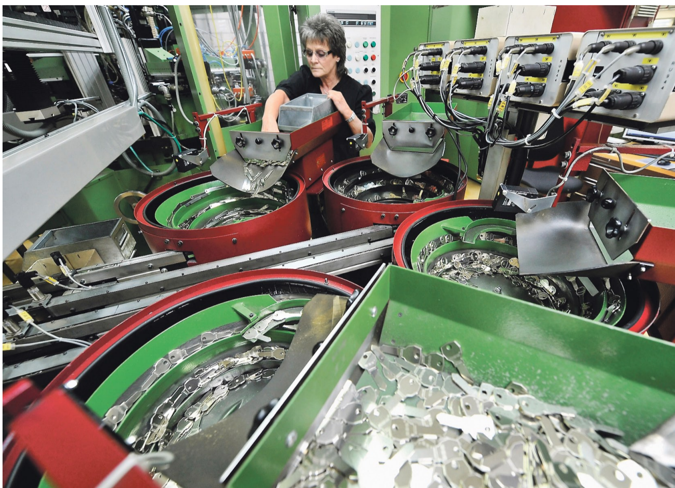
Schlüsselrohlinge in Schüsseln: SEA produziert in Zollikofen bis zu 600 Schlüssel pro Stunde. Foto: Valérie Chételat
