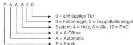
Die Schlosstypen PA 400 – 1220 und Secury 2116 – 2119 S können mit autarker Zusatzfalle am Langstulp in Kombination mit Fluchttüröffner EFF-EFF 332 als elektrisch verriegeltes Panikschloss (Secury EVP) betrieben werden. Panik nur bei freigeschaltetem (spannungslos) Türöffner EFF-EFF 332 gewährleistet. (Dann nur VS-TYP B).
